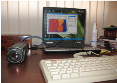
Fig.3.b: Camera Thermovision A 320 Flir en salle de soin.
